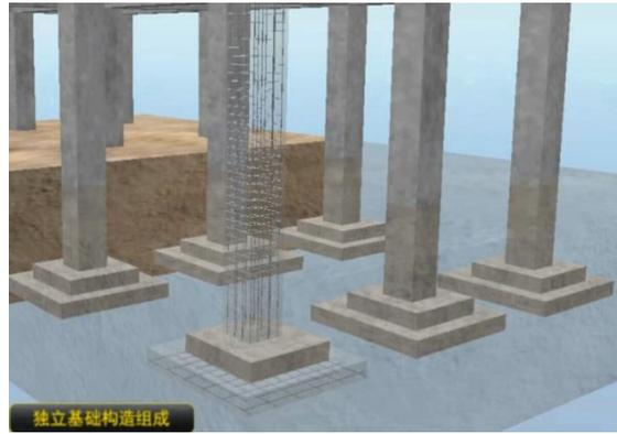
建筑物上部结构采用框架结构或单层排架结构承重时，基础常采用圆柱形和多边形等形式的独立式基础，这类基础称为独立式基础，也称单独基础。
