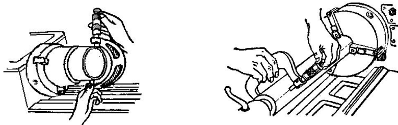
图 4-38 在车床上使用外径千分尺测量外圆的方法
